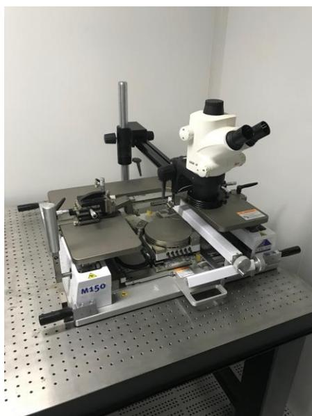
探针测试平台：一款结构简单、高精度度、多功能、高性价比 150mm 基准的探针台。该探针台采用了模块化设计，提供了众多的配置可能性，可以满足诸如单切晶至 150mm 晶圆、模块、印刷电路板组件和微流体芯片等多种器件的精密电测量的需要。
