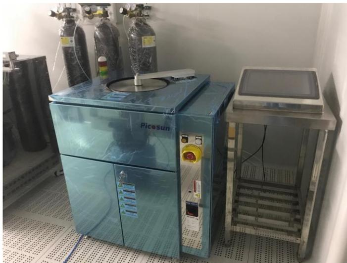
原子层沉积系统（ALD）：荷兰 Picosun SUNALE™ R-200 Series 型原子沉积系统，功能强大且多元化，不仅具有沉积单一的薄膜、纳米叠层与梯度薄膜、掺杂多组分薄膜、三元薄膜等功能，同时沉积的薄膜具有极度均匀性和高度重复性。具有在复杂基底、苛刻环境中进行沉积的能力。可以研究不同功能材料在原子级厚度下电学、光学和机械性能的变化和影响规律。
