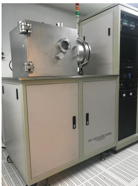
全自动离子刻蚀机：利用低能量平行  $\text{Ar}^+$  离子束对基片表面进行轰击，将基片表面未覆盖掩膜的部分溅射出，从而达到选择刻蚀的目的。用于金属、合金、氧化物、化合物、半导体、绝缘体、超导体等，适应于  $\Phi 6$  英寸以下片状或类片状样品的刻蚀。
